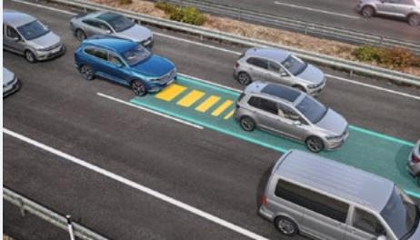
Sastrēgumu palīgsistēma palīdz saglabāt braukšanas joslu un automātiski kontrolē akseleratora un bremžu pedāli.
